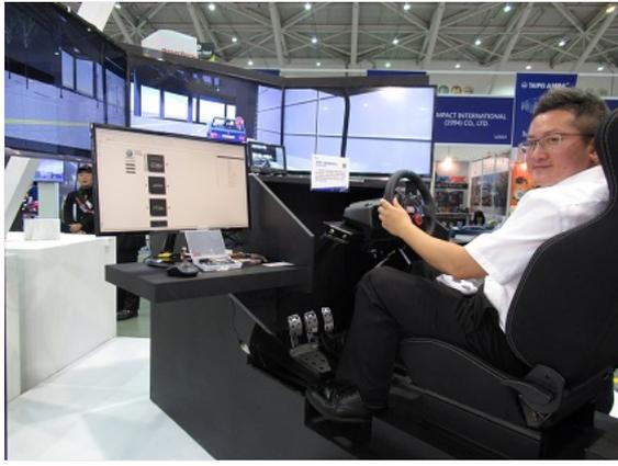
车测中心的车辆仿真器可支持ADAS算法的验证（来源：EE Times）
