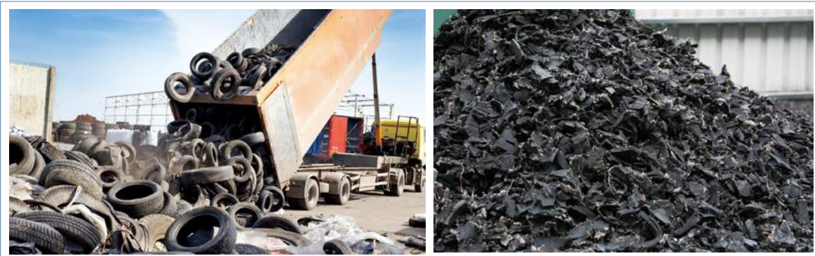
相較於煤的熱質，廢輪胎的膠片就比同樣質量的煤熱質高上 1.2~1.5 倍
