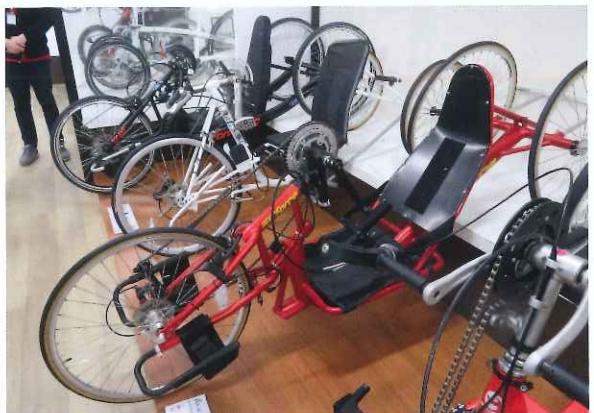
健康器具としても注目される自転車。台湾は自転車の生産国としても広く知られている。同社は1980年創業のメーカー。OEMから始め1993年にはODMを手掛けるようになり、2005年からは独自ブランド製品を送り出している。設計、製造、塗装まで自社で行う。環境保護の観点から原料にはアルミを使用。一般向け自転車のほか、特別なニーズのある人向けの「Adaptive cycles」シリーズも製造しており、手で漕ぐタイプ（写真左）、首や背中を固定できるタイプ（写真右）等をラインアップしている。これらの自転車は、デザインの細部まで考えて設計され、乗る人に合わせて調整可能となっている。
