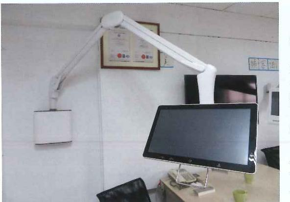
病院のベッドサイド端末などに使用されるディスプレイ用の可動アームや工業用の耐久性の高いキャスターを製造している企業。アームには装置の重量に合わせたガススプリングを組み込んでおり、バランスを保ちつつアームの調整が可能である(写真左)。ケーブルダクトがアーム内部にあるため、簡単に交換や修理ができる。清掃も容易に行えるデザインとなっている。アームは、医療機器ではないが病院で使用され高い品質が求められることから、40000サイクルを超える動作テスト(写真右)を行っている。世界的なメーカーのディスプレイに採用されており、北米・ヨーロッパ・香港などへの輸出実績がある。
