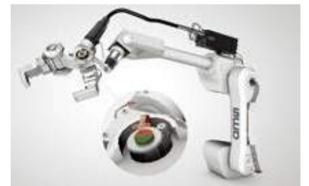
帶有磁性位置感測器的機器人手臂
