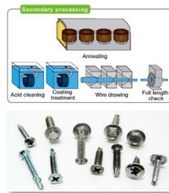
伸線、 冷打扣件
